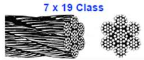
الشكل 2 - مقطع الكابل الفولاذي
