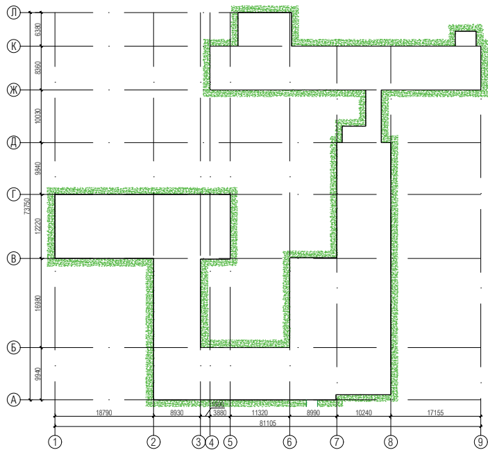
Схема улаштування вимощення
