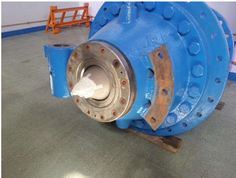
Fotografía 37 - Inyector de un grupo de SAM
