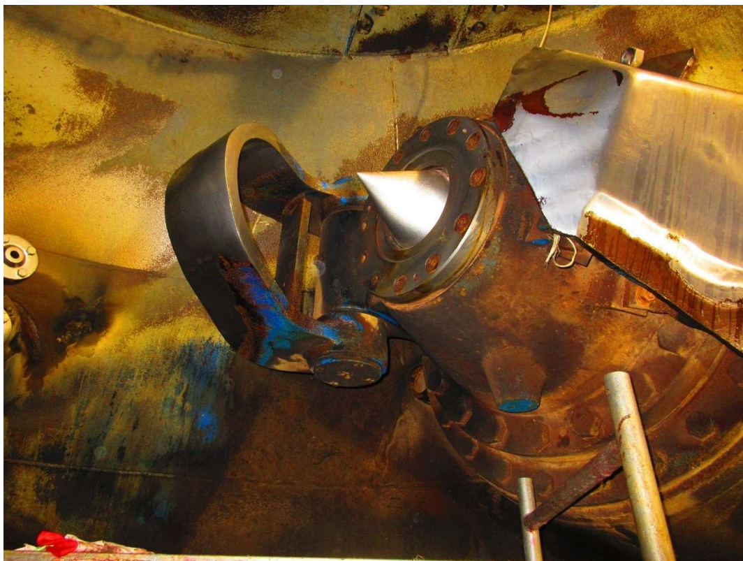
Fotografía 38 - CONjunto inyector de un grupo de SAM
