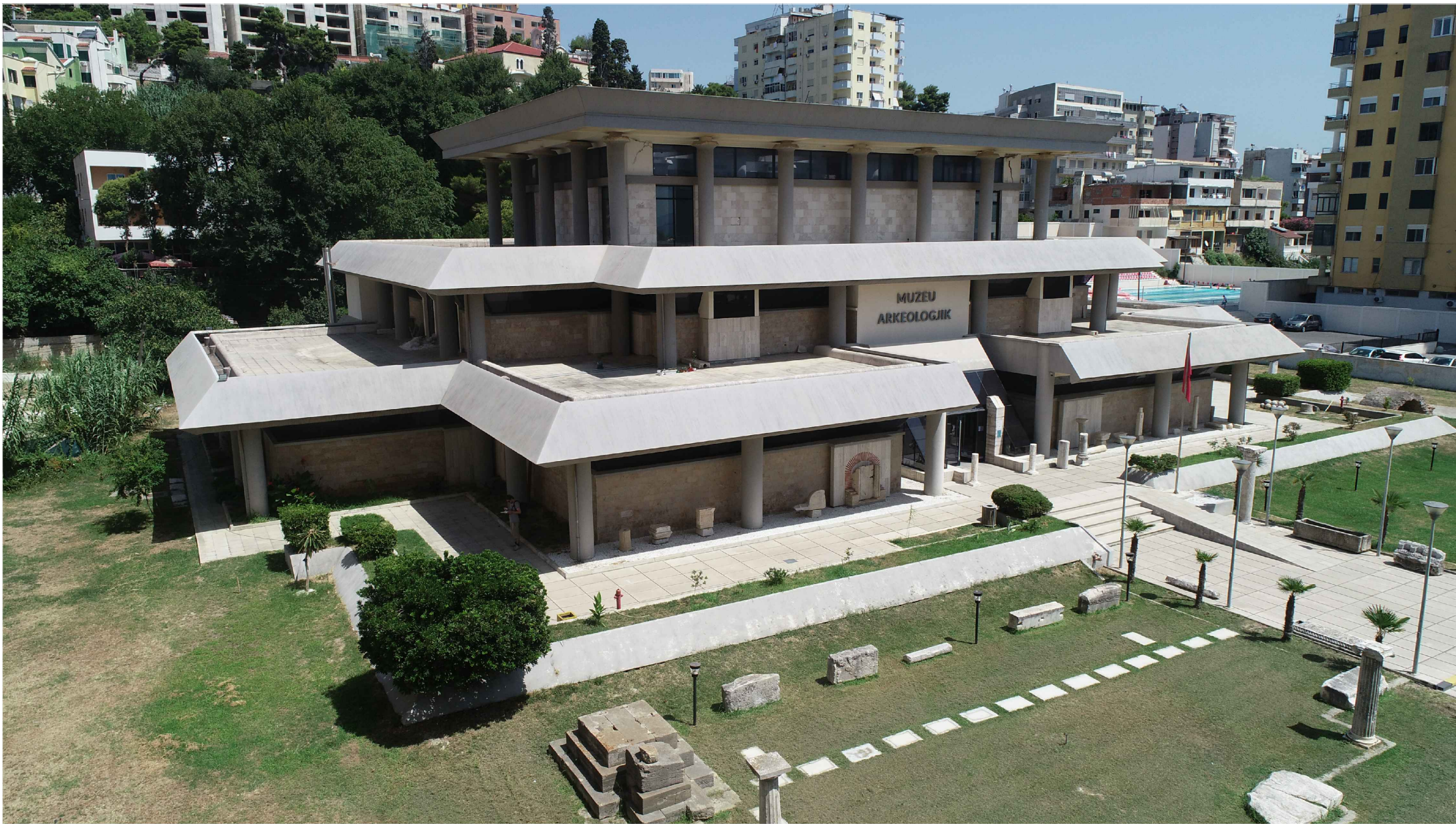
Southern Facade: The symmetry is a recurrent motif throughout the building, as is the amalgam of materials, such as: marble tiles, glass in windows, concrete on the balconies and the columns and lastly, plaster on the columns or small areas of the facades / Fasada jugonë: Simetria përsëritet në të gjithë objektin, ashtu sikurse dhe ndërthurja e materialeve: pllaka mermeri, xham në vetrata, beton në ballkone dhe kolona dhe suva në kolona apo dhe në sipërfaqe të vogla të fasadave.
