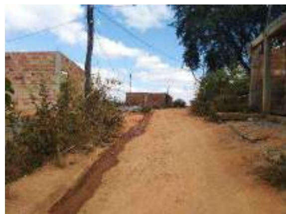
Foto 141 - [C] Rua Dandara da Vitória Algumas das intervenções necessárias são: aumento de largura de via, obras geotécnicas nos taludes, e estudo de edificações a serem removidas
