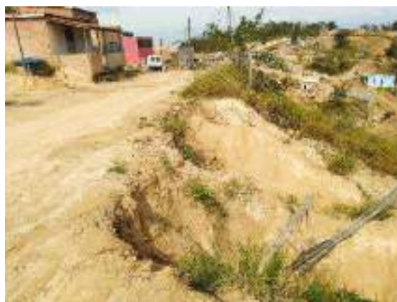
Foto 142 - [D] Av. dos Milagres Algumas das intervenções necessárias são: obras geotécnicas nos taludes, drenagem e estudo de edificações a serem removidas
