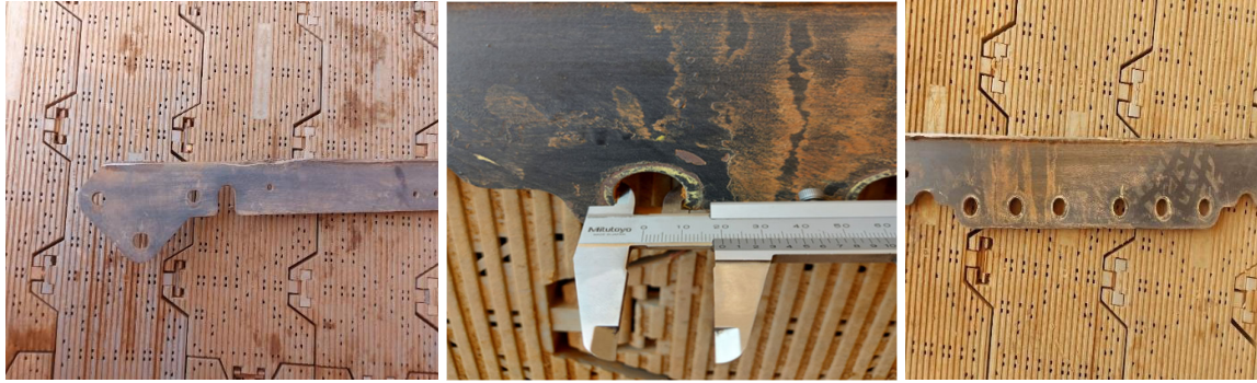
Photos de la plaque d'adaptation avec des trous
