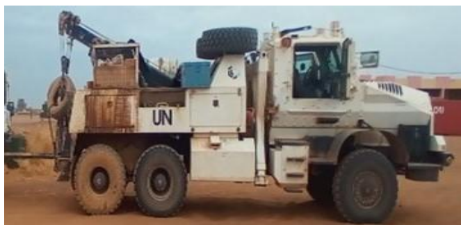
Camion avec unité de récupération et bacs latéraux équipés
