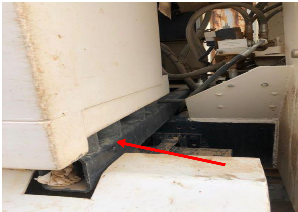
Poutre de support avant du bac latéral
