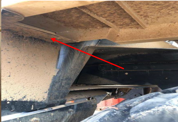
Fixation arrière du bac latéral
