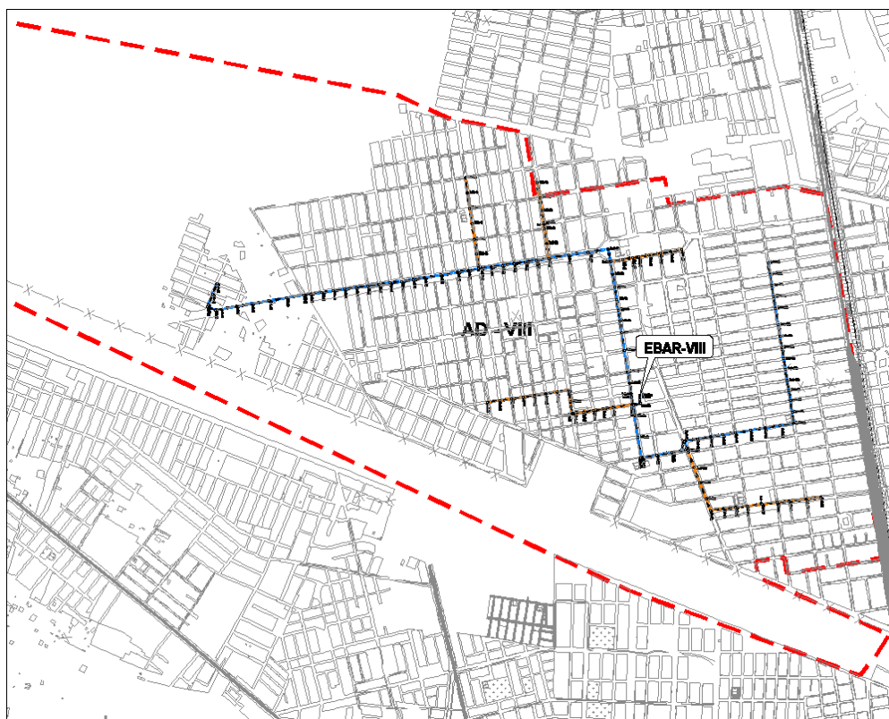
Figura N° AL-08: Esquema de la distribución de colectores del AD-VIII
