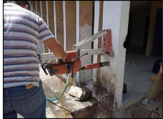
Extracción de núcleo
