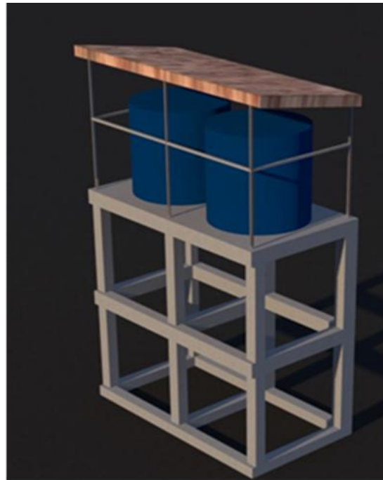
Schéma de la tour du château avec 2 réservoirs de 5000 litres
